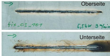
**Bild 5.25:** Ungeregelte Durchschweißung mit 10 % Leistungsüberschuss am I-Naht-Überlappstoß. Die Schweißparameter sind:  $v = 9 \text{ m/min}$ ,  $P = 5,5 \text{ kW}$ , verzinktes Stahlblech  $2 * 0,7 \text{ mm}$  mit  $0,1 \text{ mm}$  Zinkentgasungsspalt [105].
