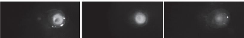
**Bild 2.14:** Bildfolge der AA6012-Schweißung (3 kW, 4 m/min).
