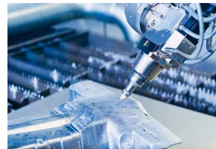
Fortschritt in der Lasertechnik: eine industrielle TRUMPF 3-D-Laserschneid-anlage, wie sie am IFSW verwendet wird
