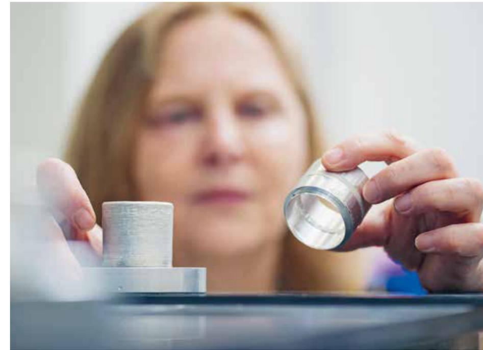
**Oben: Dr. Dina Becker prüft die Formgenauigkeit des zylindrischen Testbauteils.**
